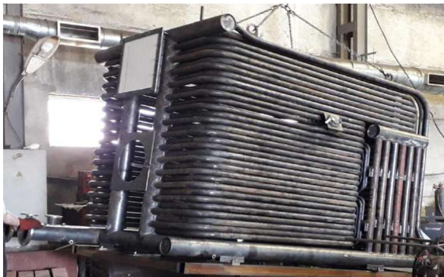
Трубная часть котла ТГ-59
