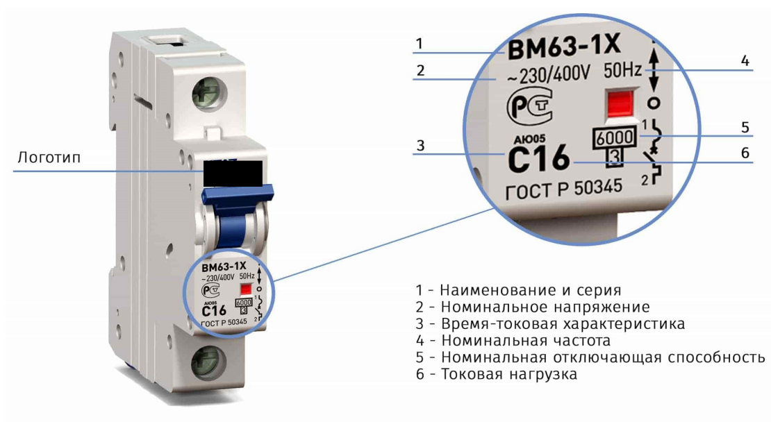
Рисунок 2. Пример маркировки АВ
