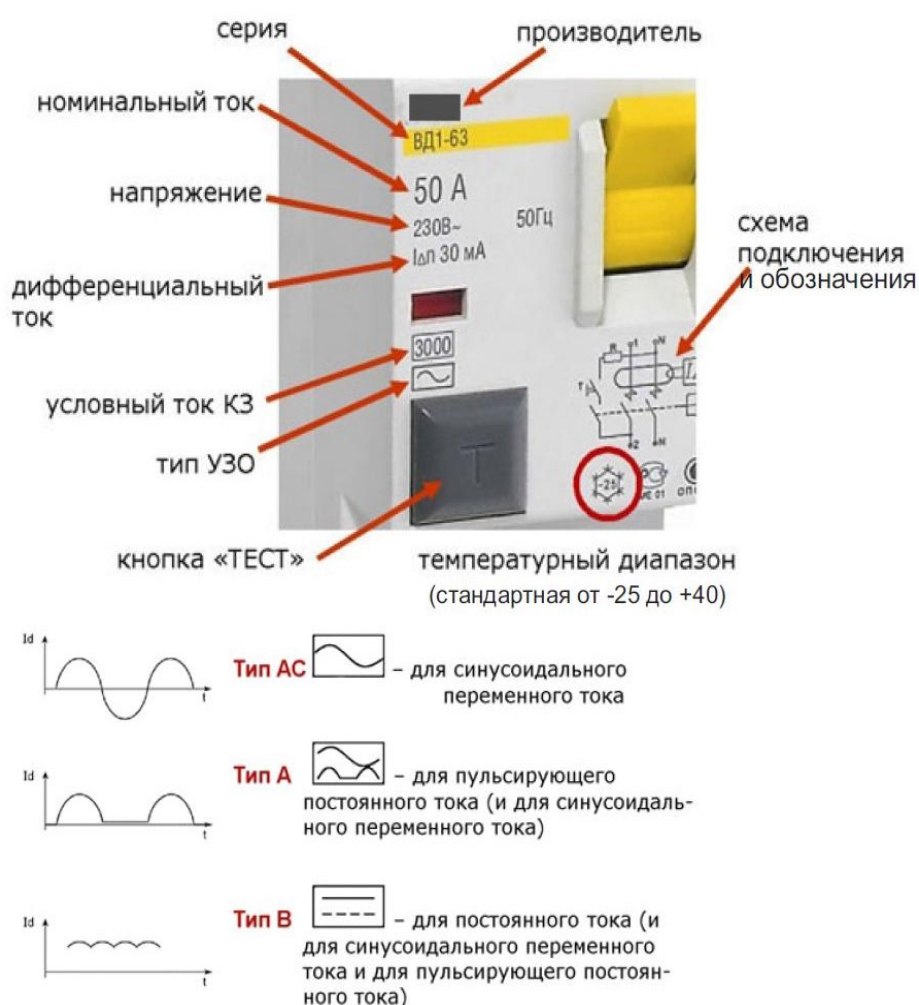
Рисунок 5. Маркировка УДТ
