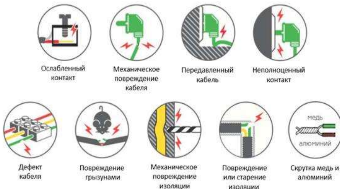
Рисунок 6. Возможные причины искрения в электропроводке
